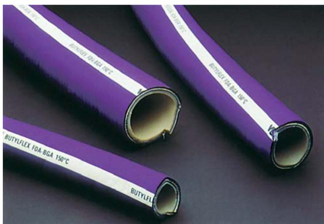
Kautschukschlauch, hergestellt aus lebensmittelechtem Butylkautschuk gemäß FDA 21 CFR 1772600 und BGA Klasse XV, mit Textileinlagen, doppelter Edelstahlspirale 304L und Kupfergeflecht für eine elektrische Entladung.
