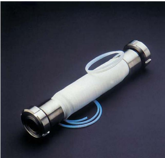
Diese Silikonschläuche werden aus einem Silikonwerkstoff der Lebensmittelqualitätsklasse VMQ gemäß FDA 21 CFR 177.2600 und BGA Klasse XV, hergestellt, ebenso die Reihe **TechnoFood** und **TechnoPharm**. Diese Schläuche werden innen mit einem Teflonschlauch versehen, der über die Gesamtlänge des Schlauches eingebaut ist; der Anschluss erfolgt an den jeweiligen Schlauchenden.
