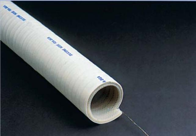
Zur Herstellung dieser Silikonschläuche wird Silikon der Lebensmittelqualitätsklasse VMQ gemäß FDA 21 CFR 177.2600 und BGA Klasse XV verwendet, ebenso für die Reihe **TechnoFood** und **TechnoPharm**. Parallel zur Stahldrahtspirale werden mehrere Kupferdrähte eingearbeitet, die an den Erdanschluss angebracht werden und somit keine statische Elektrizität weiterleitet.
