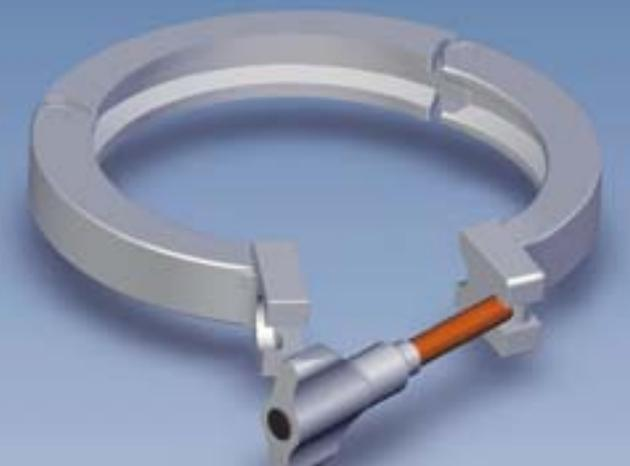
Die speziell verengte Führung an der Klammer und der speziell geformte Flügel stellen sicher, dass die Klammer nicht aufgeklappt werden kann, solange die Profilhälften noch klemmen und die Klemmring-Verbindung unter Druck steht.
